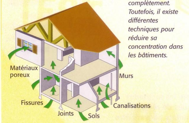
**Exemple 1 : étanchéification des voies d'entrée du radon**
